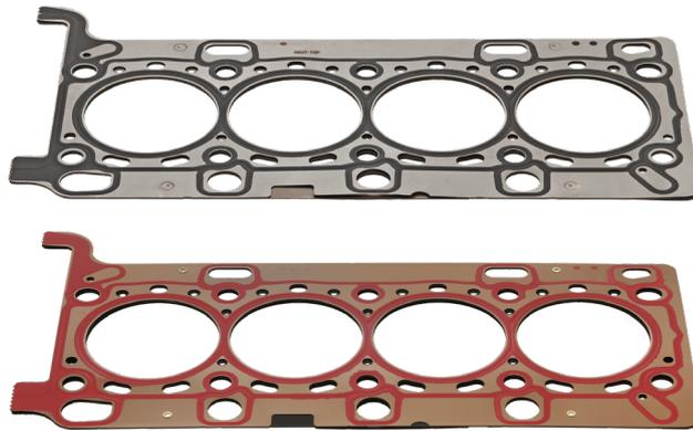
Un'ulteriore modifica riguarda la tecnica di giunzione dei singoli strati metallici. La guarnizione non più in produzione con il numero articolo 598.670 era saldata in quattro punti. Nella guarnizione successiva con numero articolo 867.700 gli strati metallici sono rivettati gli uni con gli altri. Sostanzialmente non cambia nulla nel montaggio della guarnizione per testata cilindro.
