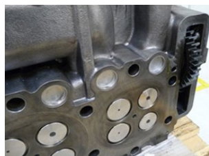
Superficie de estanqueización de la culata con rueda dentada recta
