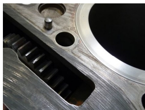
Superficies de estanqueización del bloque motor con rueda dentada recta
