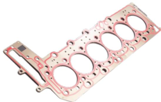
Le guarnizioni per testata cilindro in metallo/elastomero sono costituite da supporti metallici con profili elastomerici applicati mediante vulcanizzazione concepite per i motori ad elevate prestazioni, con turbocompressore e intercooler, utilizzati nel settore dei veicoli commerciali.
