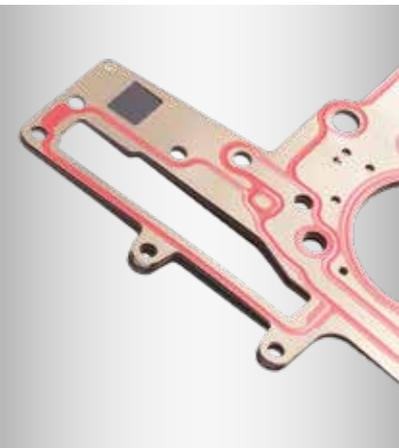
Metaloflex™ di ElringKlinger è il marchio riconosciuto a livello mondiale che identifica le innovative guarnizioni per testata cilindro multistrato, realizzate con strati di acciaio armonico provvisti di nervature e con rivestimento in elastomero per motori diesel e motori a benzina ad elevate prestazioni con iniezione diretta.
